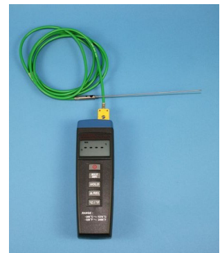
MIN/MAX Thermometer mit zusätzlichem Temperaturfühler
